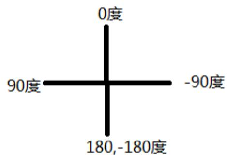
图 18 YDLIDAR TEA 坐标角度定义
