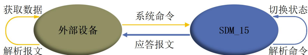
图 1 YDLIDAR SDM15 系统通信机制
