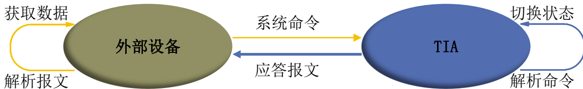
图 1 YDLIDAR TIA 系统通信机制
