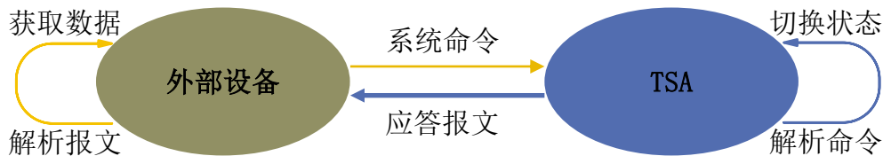
图 2 YDLIDAR TSA 系统通信机制
