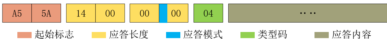
图 8 YDLIDAR G6 设备信息报文示意图
