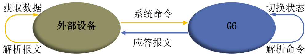
图 2 YDLIDAR G6 系统通信机制
