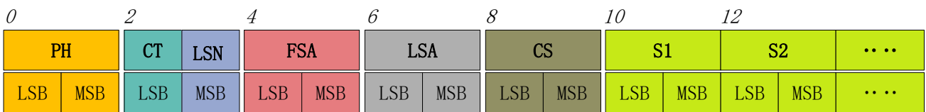
图 5 扫描命令应答内容数据结构示意图
